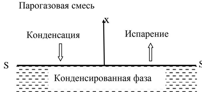
Рис. 2. Схема одномерной задачи о конденсации или испарении пара на межфазной границе в парогазовую смесь.
