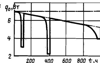
Рис. 4.11. Изменение холодопроизводительности ГKM во время ресурсных испытаний
